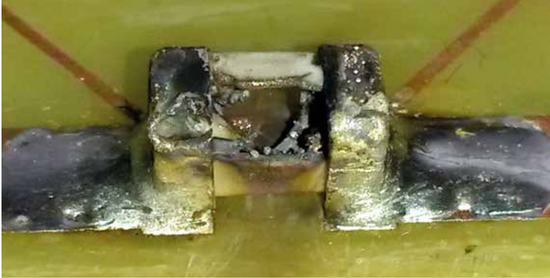
Bild 1: SMD-Sicherung, die nicht ordnungsgemäß abgeschaltet hatte.
