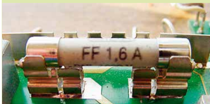
Bild 1b Sicherungshalter auf der Leiterplatte
