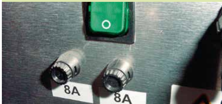
Bild 1a Sicherungshalter an der Gehäuserückwand
