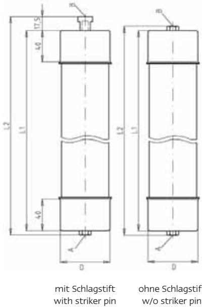
**Beidseitiges Innengewinde / Both ends female thread**
