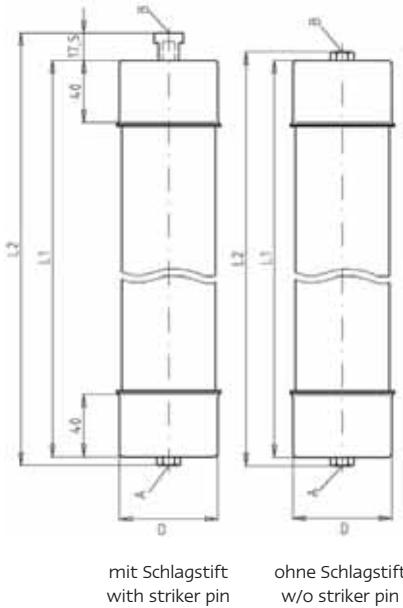
**Beidseitiges Innengewinde / Both ends female thread**
