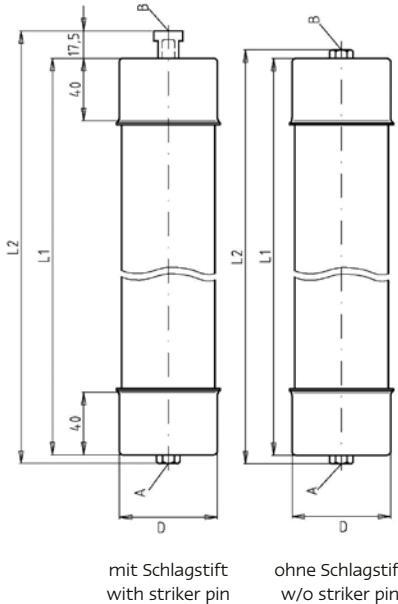
Beidseitiges Innengewinde / Both ends female thread
