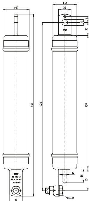
Transformatorschutz in Freileitungsnetzen/
