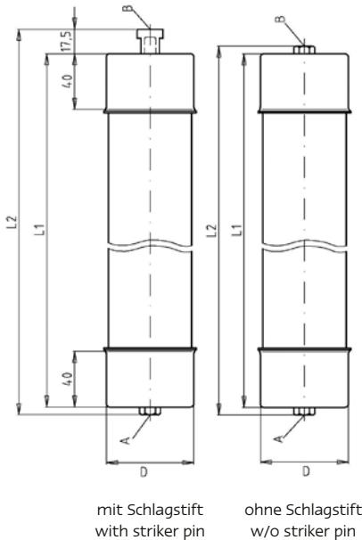
Beidseitiges Innengewinde / Both ends female thread
