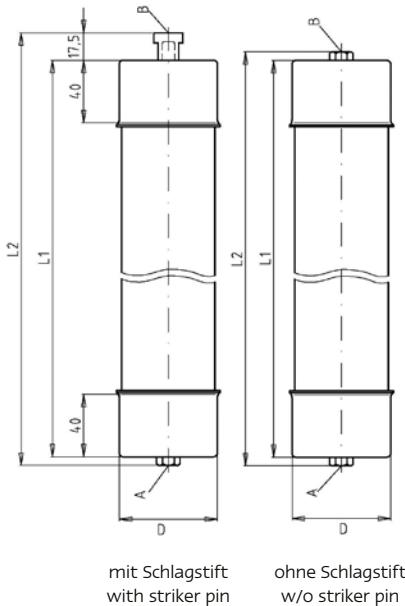
Beidseitiges Innengewinde / Both ends female thread
