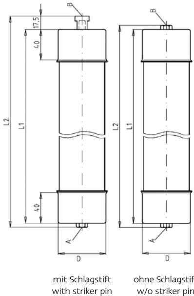
Beidseitiges Innengewinde / Both ends female thread
