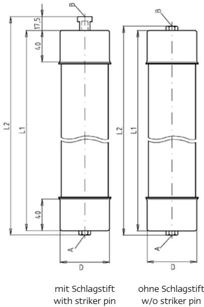
Beidseitiges Innengewinde / Both ends female thread
